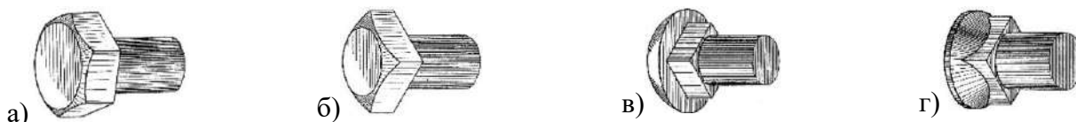
Рисунок 7 Формы головок болтов: а – шестигранная, б – квадратная, в - сферическая с квадратным подголовком, г – потайная с квадратным подголовком
