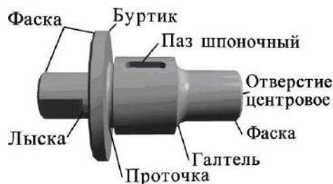
Рисунок 2 - Конструктивные элементы детали
