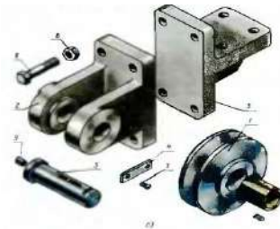
Рисунок 2 Составные части «Блока направляющего»
