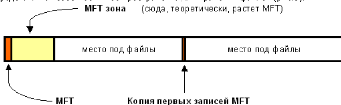
Рис. 3. Структура раздела NTFS
