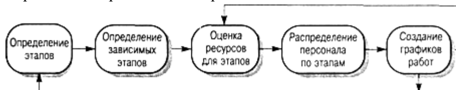
Рис. 2.- Процесс составления графика работ
