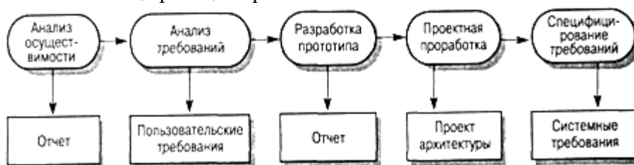
Рис. 1. Этапы процесса разработки спецификации
