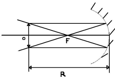
3. Измерить расстояние между экраном и вогнутым зеркалом ( $f$ ) и между вогнутым зеркалом и предметом ( $d$ ). Рассчитайте фокусное расстояние ( $F_1$ ) по формуле  $F=R/2$  и  $d=R$ .
