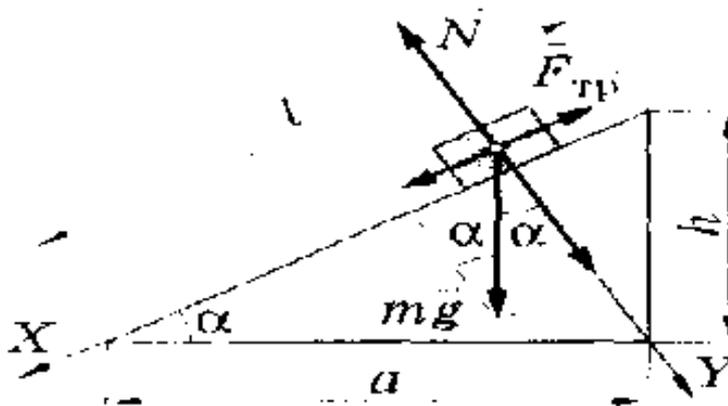
Рассматриваем движение тела в двухмерном пространстве: ось  $X$  совместим с наклонной плоскостью, тогда ось  $Y$  совпадёт с направлением силы реакции опоры, т.е. перпендикулярно (рис. 4). Наклонная плоскость образует угол  $\alpha$  с горизонталью, тогда второй закон Ньютона на ось  $X$  запишется следующим образом:
