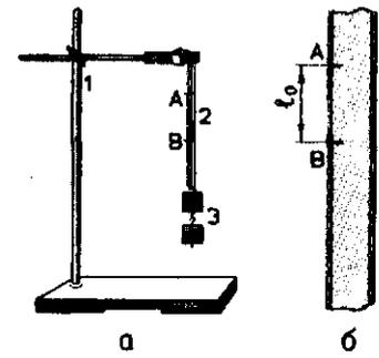
Модуль Юнга зависит только от свойств материала и не зависит от размеров и формы тела. Для различных материалов модуль Юнга меняется в широких пределах. Для стали, например,  $E \approx 2 \cdot 10^{11} \text{Н/м}^2$ , а для резины  $E \approx 2 \cdot 10^6 \text{Н/м}^2$ , то есть на пять порядков меньше.
