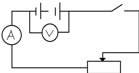
2. Снимите показания амперметра и вольтметра при замкнутом ключе и запишите их в таблицу.
