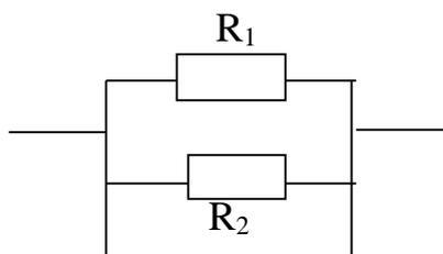
Соединение, при котором резисторы имеют две общих точки называется параллельным.
