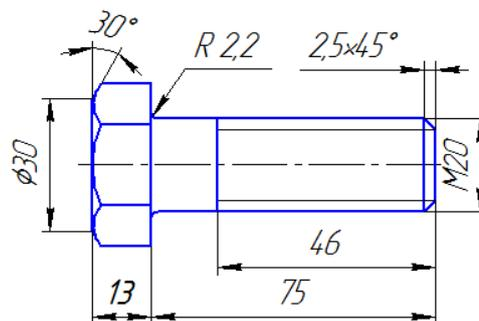
**9 Какое из обозначений соответствует изображенной на чертеже шпильке**
