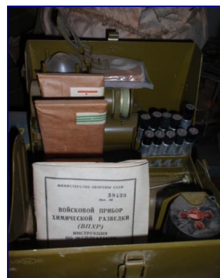
Рис. 7. Войсковой прибор химической разведки (ВПХР): 1 - ручной насос; 2 - плечевой ремень с тесьмой; 3 - насадка к насосу; 4 - защитные колпачки для насадки; 5 - противодымные фильтры; 6- патрон грелки; 7 - электрический фонарь; 8 - корпус грелки; 9 - штырь; 10 - лопатка; 11 - индикаторные трубки в кассетах
