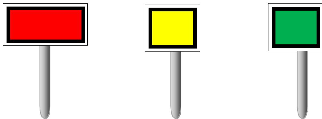
Переносными сигналами предъявляются требования: прямоугольной щит красного цвета (или красный флаг на шесте) днём и красный огонь фонаря на шесте ночью – «Стой! Запрещается проезжать сигнал»
