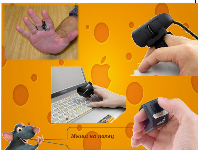
А эта мышь, по-моему, инопланетянин. Новое устройство управления компьютером крепится к запястью и двум пальцам: среднему и указательному. На внутренней стороне ладони располагается, привычный уже в компьютерных мышках, лазер, отслеживающий перемещение.
