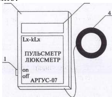
Рис. 3. Внешний вид люксметра-пульсметра «Аргус-01»
