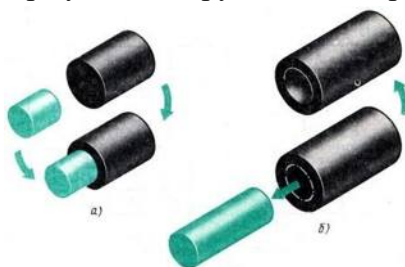
Рисунок 1 Деталь как сумма или разность геометрических тел
